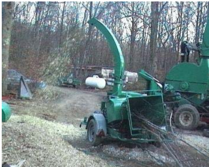
Photo n° 78 : Broyeur de végétaux, modèle de grande capacité pour chantier pontuel
